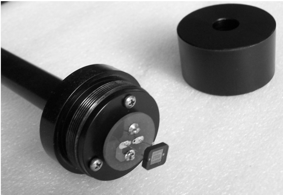
图 20 光电传感器更换示意图
