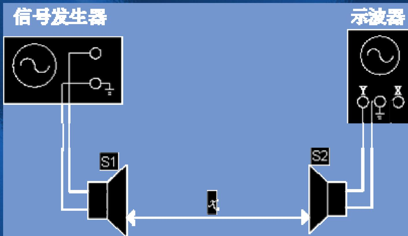
在驻波测量中 $S_1$ 为发射器， $S_2$ 为接收器， $S_2$ 将接收到的信号转换为同频率的正弦电压信号接入示波器。连续移动 $S_2$ 的位置，当 $S_1$ 、 $S_2$ 间距恰好为超声波半波长的整数倍时，即
