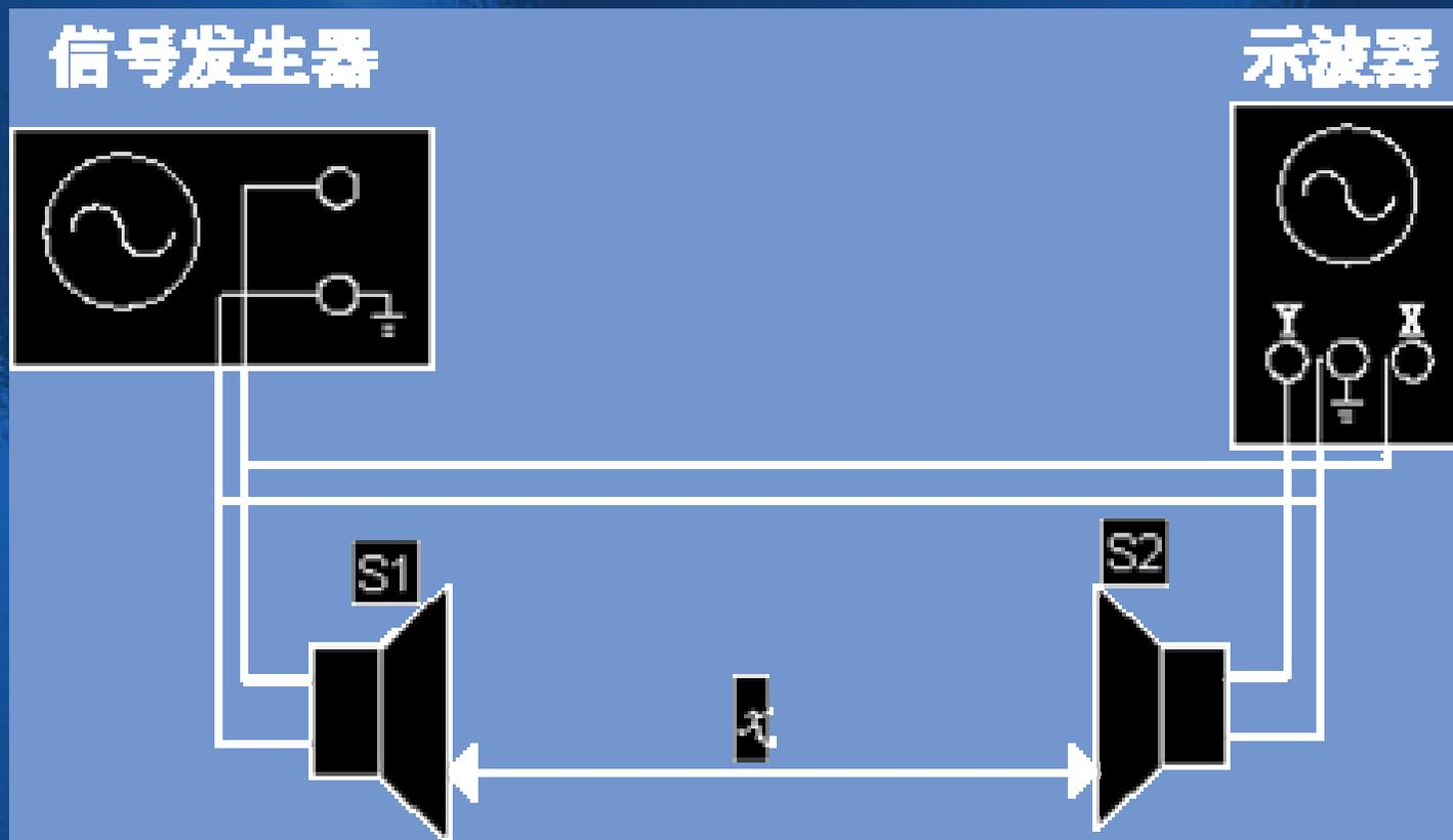
从换能器 $S_1$ 发出的超声波到达接收器 $S_2$ ，所以在同一时刻 $S_1$ 与 $S_2$ 处的波有一相位差：
