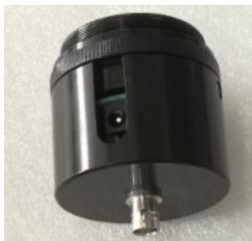
图 3 光电二极管探测器模块图
